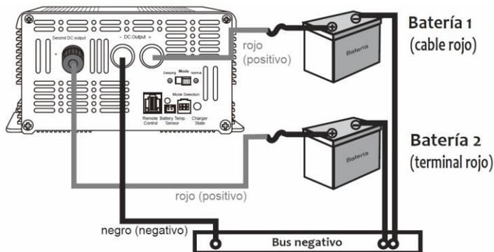
Si solo tiene una batería, conecte el cable de la batería 1 (principal) y deje sin conectar el terminal de la batería 2 (secundario).
